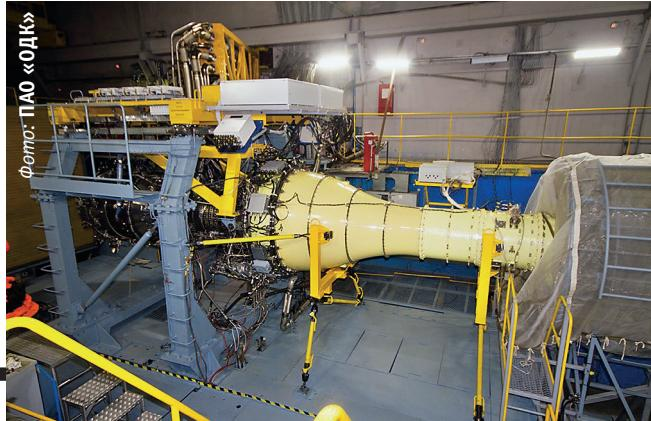
**Сборка демонстрационного газогенератора двигателя ПД-35**
